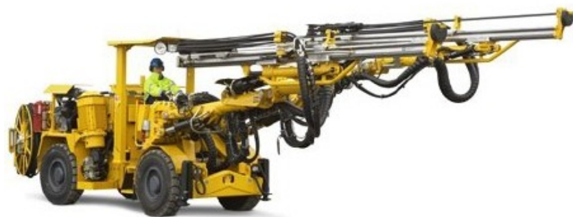
Рис. 2.2. Бурова установка Atlas Copco Boomer 282
