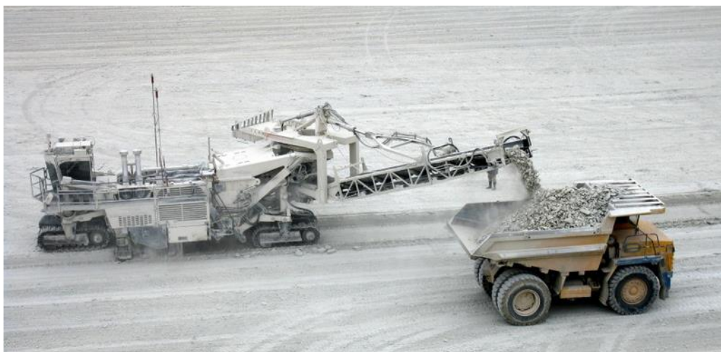
Рис.4. Робота комбайна Wirtgen 2200 SM з автосамоскидом
