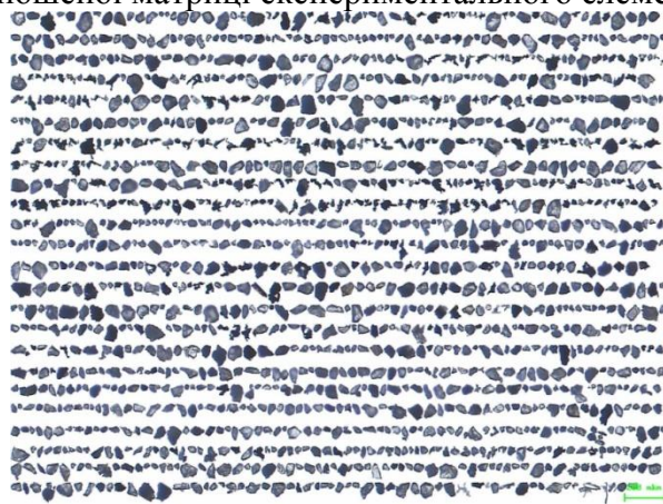
Рис. 4. Видалена методом магнітної сепарації низка продуктів руйнування гірської породи алмазним інструментом упереміш з продуктами зношування його матричного матеріалу, отримана за допомогою мікроскопа DiaInspect OSM фірми VOLLSTADT DIAMANT GmbH , мітка –200 мкм
