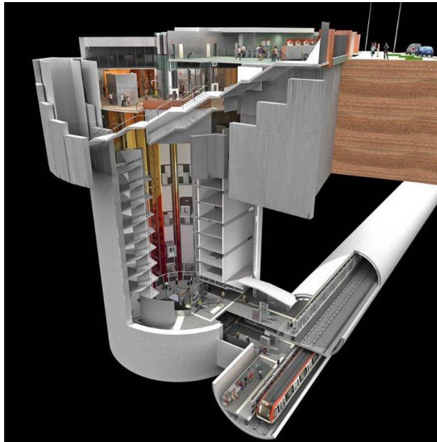
Рис. 5. Конструкція станції дворівневої лінії метрополітену
