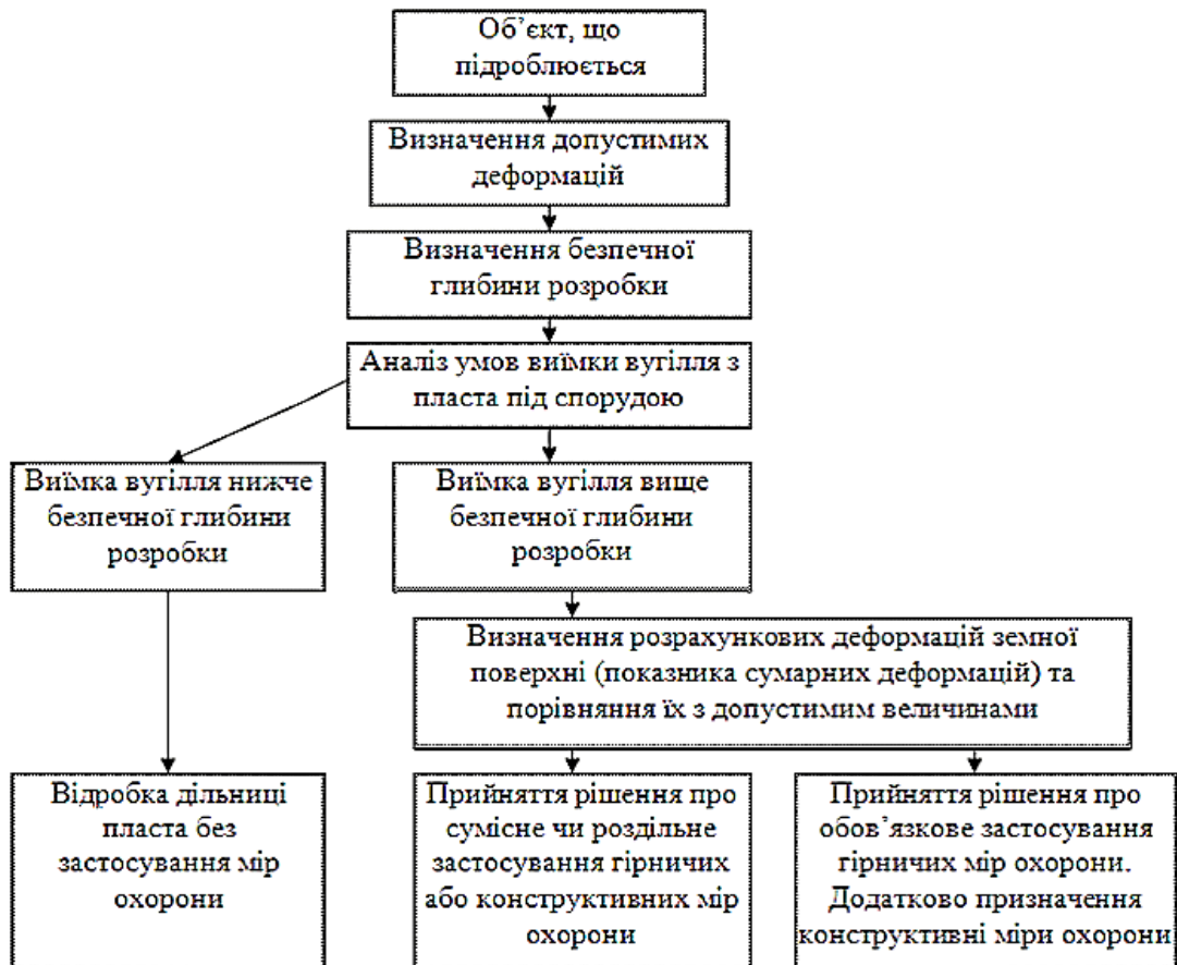
Рис. 2. Схема до визначення мір охорони споруд, що підроблюються
