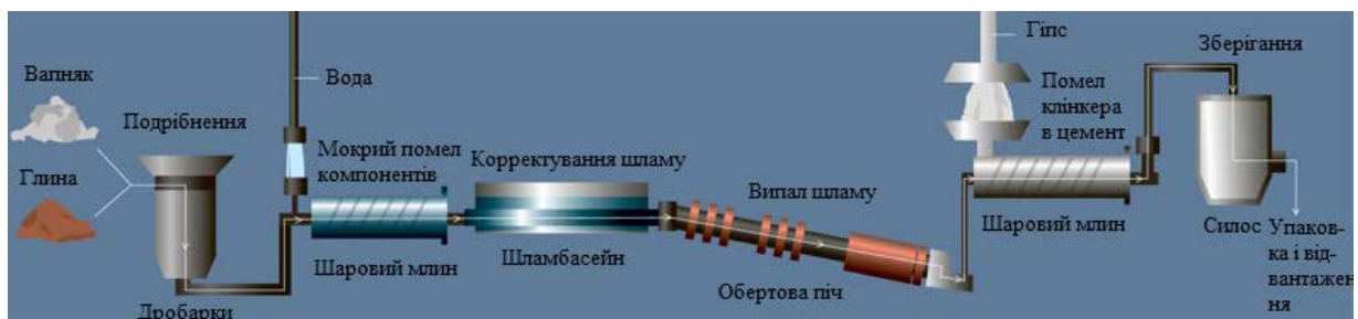
Рисунок 1 – Мокрий спосіб виробництва портландцементу
