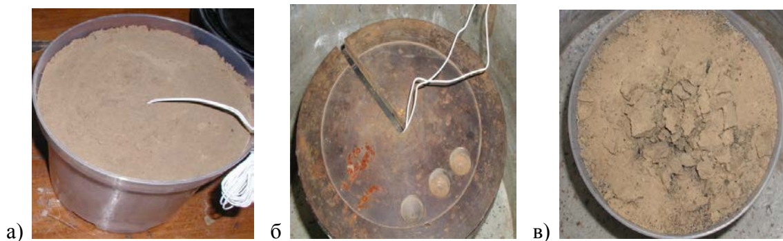
Рис. 1 – Етапи проведення досліджень: а – зразок ґрунту із встановленим зарядом; б – зразок під час проведення вибуху; в – зразок після проведення вибуху.
