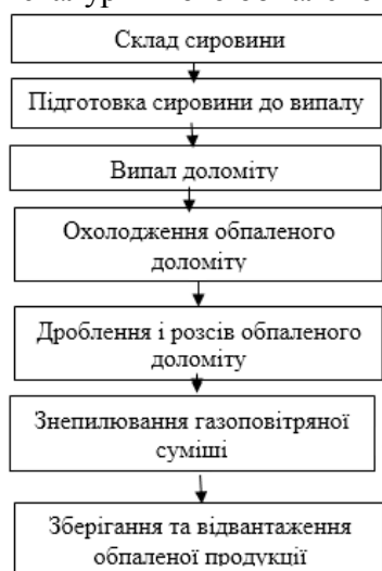
Рисунок 1 – Технологічна схема виробництва доломіту
