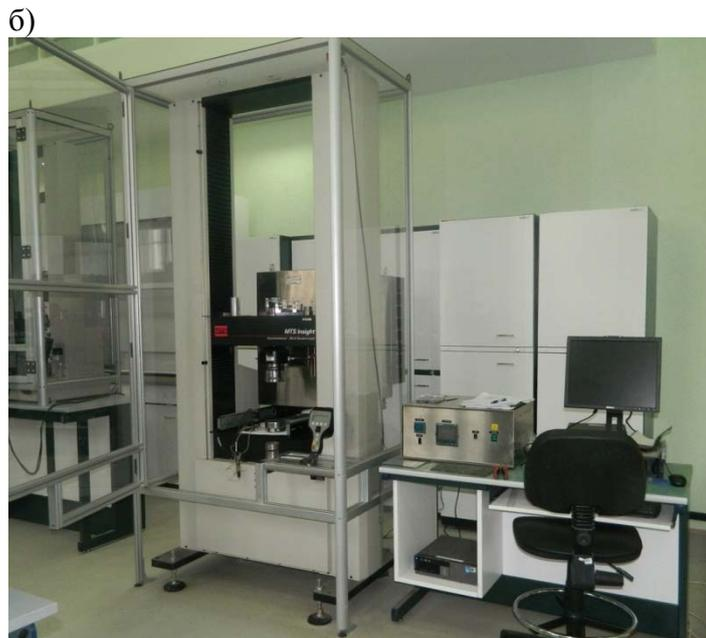
Рис. 1 - Вид прессовой установки MTS 816 (а) и испытательной машины MTS Insight 200 кН (б).
