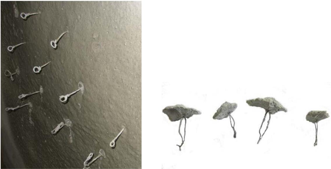
Рис. 2. – Обнаженная поверхность после нанесения набрызг-бетона и характер отрыва пластин
