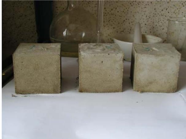
Рис. 2. Дослідні зразки-куби після звільнення із металевих форм.
