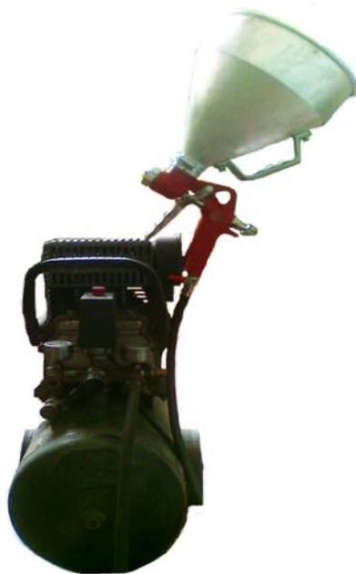
Рис. 1 - Лабораторная установка для нанесения набрызг-бетона
