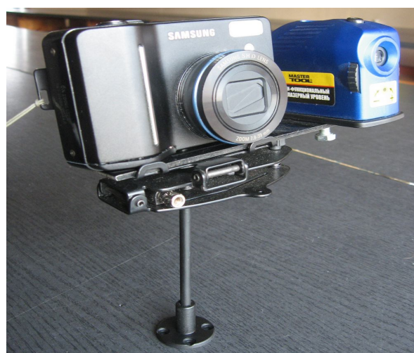
Рис. 2. Съемное крепление для цифровой наземной съемки
