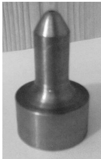
Рис.1 - Рефрактор для перерозподілу продуктів вибуху
