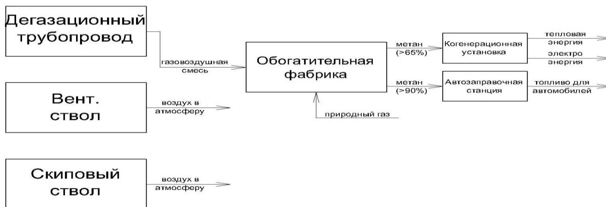
Рис. 2 — Схема добычи и использования метана путем предварительного его обогащения природным газом
