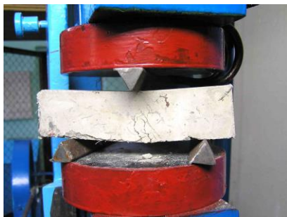
Рис. 1 - Випробування бетонного зразка армованого
