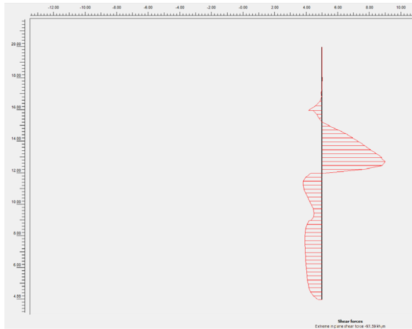
Рисунок 5 - Зсувні зусилля в підпiрній стiнцi
