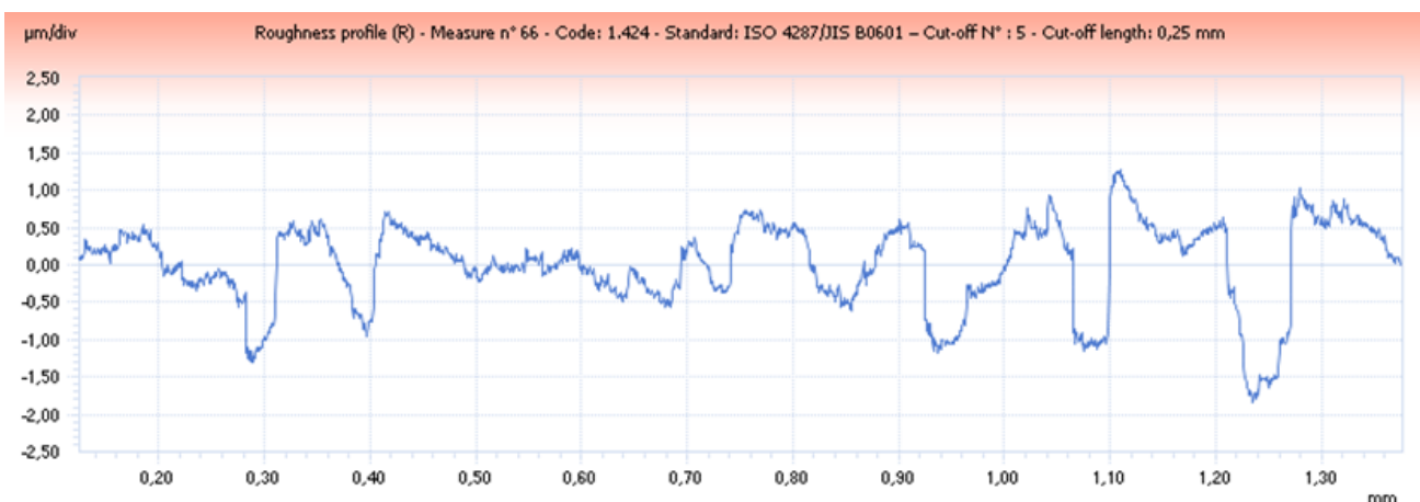
Рисунок 3 – Крива шорсткості профілю
