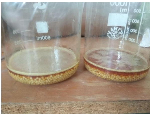
Рис. 2. Проби аміачної селітри, змішаної з індустріальною оливою
